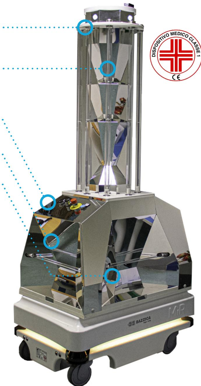
A seguito della fase di configurazione iniziale vengono effettuati i percorsi e definite le zone di fermo in cui il robot deve azionare le lampade. R2S Robot una volta impostata la missione **si muoverà in completa autonomia** fino al termine dell’attività di disinfezione.
